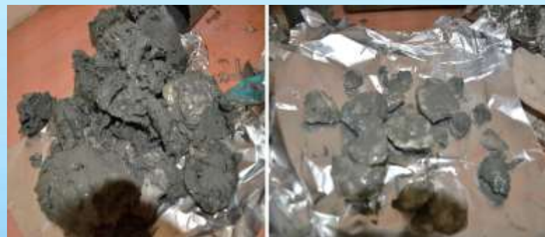
2015年通过重力取样器采集的南海海底浅表层水合物
