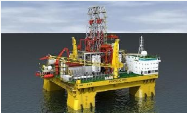
第四代半潜式平台 D90 号 最大工作水深 3658 米
