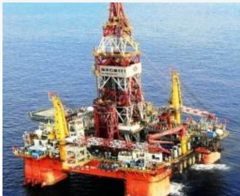
半潜式平台 981 号 最大工作水深 3000 米
