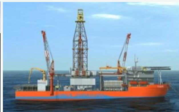
锚固钻探船老虎 1 号 最大工作水深 1500 米
